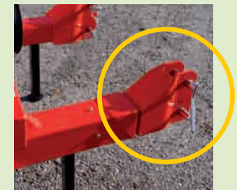
Sicherheitseinrichtung mit Rückkehr-Druckfeder Sicurezza meccanica con molla di richiamo Mechanical breakaway through recovery spring Sécurité mécanique par ressort Seguridad mecanica con resorte de vuelta
