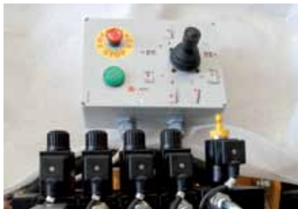
ELEKTRISCH-PROPORTIONALER STEUERGERÄT MIT JOYSTICK DISTRIBUTORE ELETTRICOPROPORZIONALE CON JOYSTICK ELECTRIC DISTRIBUTOR WITH PUSH-BUTTON PANEL DISTRIBUTEUR ELECTRIQUE PROPORTIONNEL AVEC JOYSTICK DISTRIBUIDOR ELECTRICO PROPORCIONAL CON JOYSTICK
