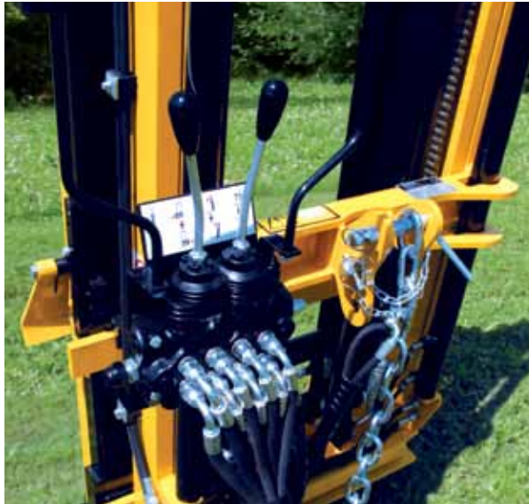
STEUERGERÄT MIT 2 CLOCHE HEBELN DISTRIBUTORE A 2 LEVE CLOCHE 2 LEVERS CLOCHE DISTRIBUTOR DISTRIBUTEUR A 2 LEVIERS CLOCHE DISTRIBUIDOR 2 PALANCAS
